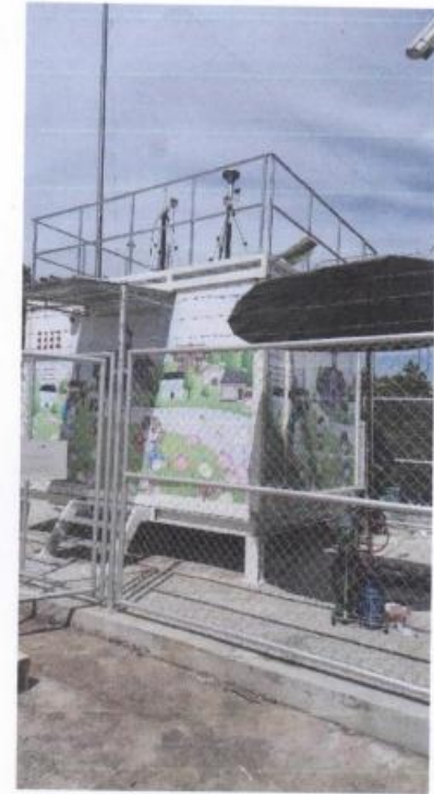
สถานีตรวจวัดคุณภาพอากาศในพื้นที่ (โรงไฟฟ้าบางปะกง ผู้ติดตั้ง)
